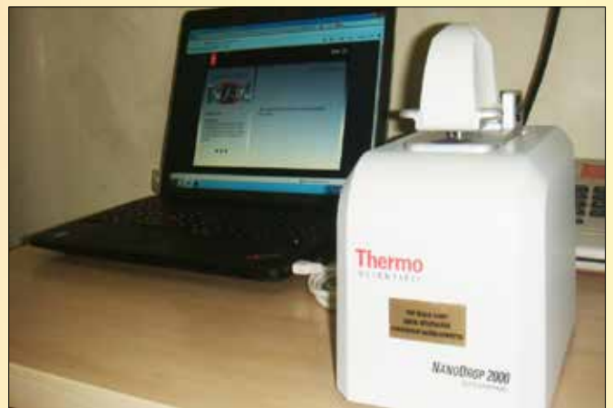
UV-VIS SPEKTROFOTOMETRE CİHAZI: Cihaz, konsantrasyon ve kalite ölçüm amaçlı kullanılmaktadır.
