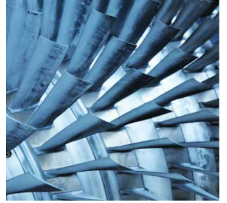
Resim-9 : Bileşik Metal Olan Jet Motoru Gövdesi (Süper Alaşım (Nikel))
